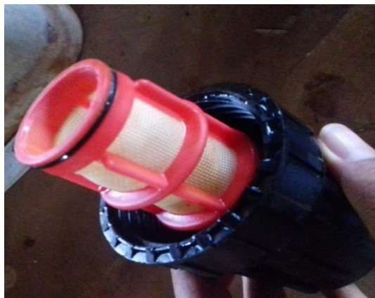
Figura 7. Filtro após a verificação do entupimento.
